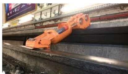
Equipement de coupeur pour vérifier l'absence de tension
